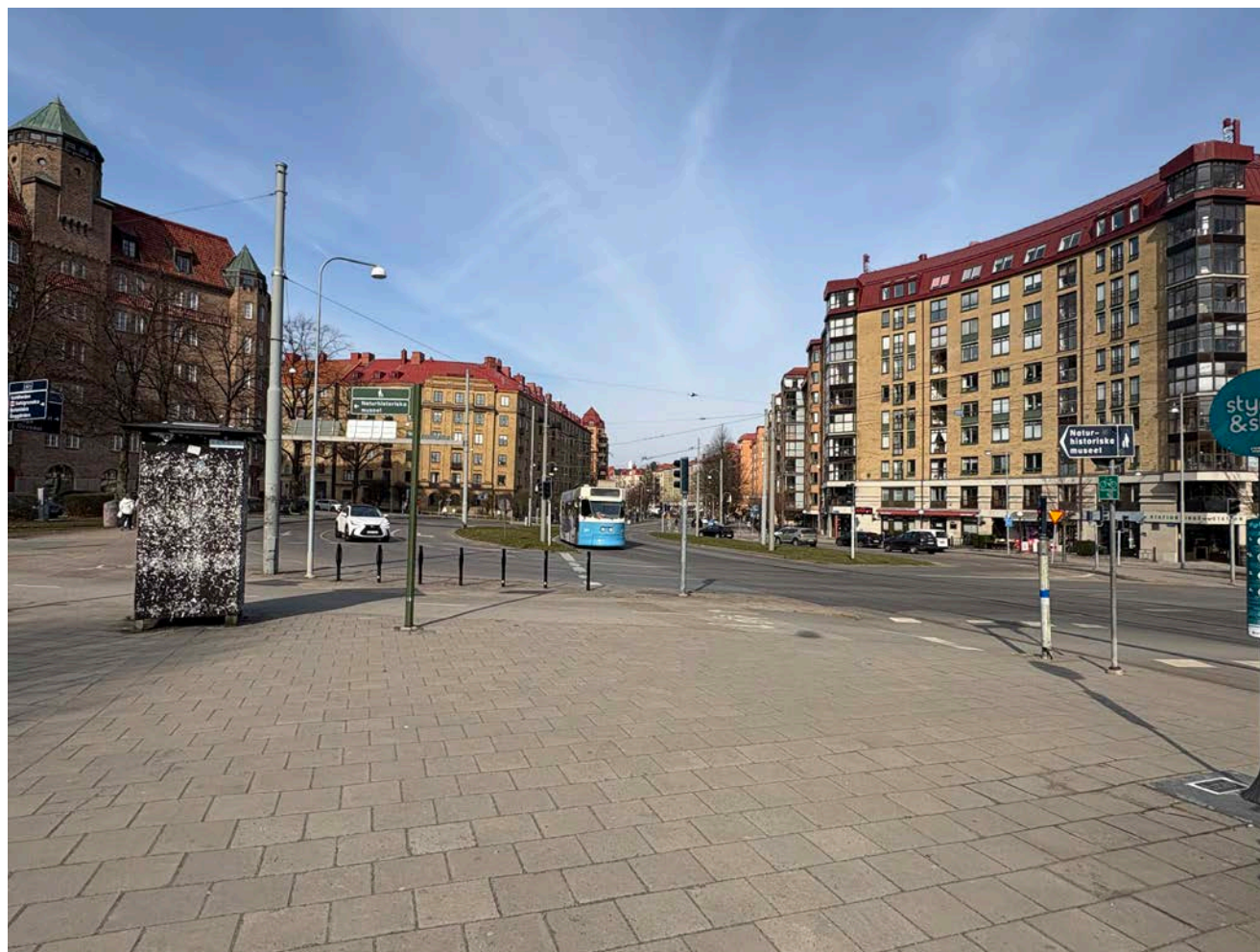
Inom Linnéplatsens hållplatsområde är stora delar av gångytorna belagda med betongplattor medan körvägarna är asfalterade. Strängar av gatsten skiljer i flera fall gångytorna från bilvägen. Till vänster i bild syns kv Malmgården, i mitten kv Bäckebron och till höger kv Slottskogsledet. De höga fasaderna ger platsen en tydlig rumslighet.
